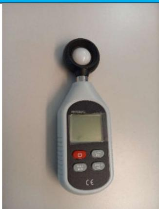
Ein Luxmeter misst die Beleuchtungsstärke in einem Raum oder an einem bestimmten Ort. Es wird verwendet, um sicherzustellen, dass die Beleuchtung den erforderlichen Normen entspricht, besonders in Arbeitsumgebungen.
